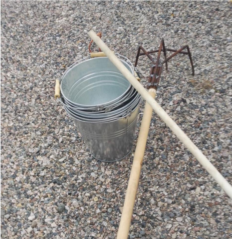
Kuva 1. VESKU II-hanke valmisti purokunnostuksia varten 2 kpl. Hartijoki-mallisia pohjarahvoja ja 10 kpl kahluusauvoja käsilenkeillä. Välineet ovat jatkossa vapaasti lainattavissa.
